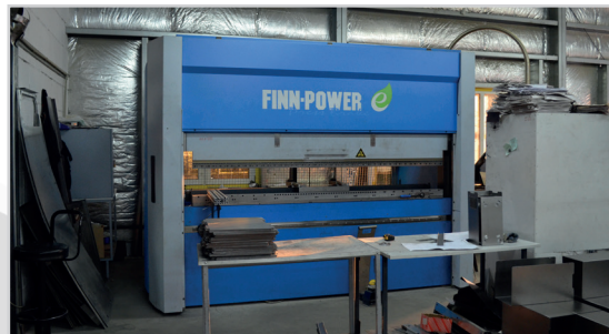
СЕРВОМЕХАНИЧЕСКИЙ ЛИСТОГИБОЧНЫЙ ПРЕСС FINN-POWER С СИСТЕМОЙ ЧПУ
