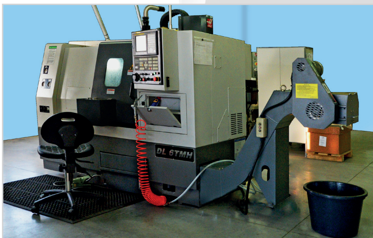
ТОКАРНО-ФРЕЗЕРНЫЙ ОБРАБАТЫВАЮЩИЙ ЦЕНТР С ЧПУ DMC
