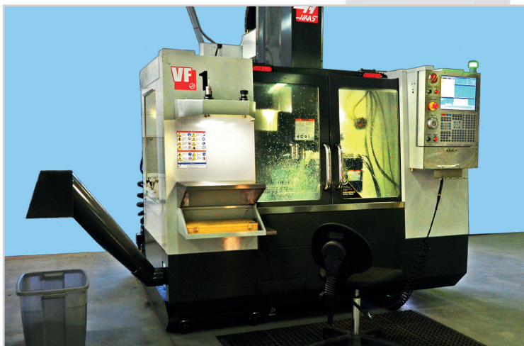
ВЕРТИКАЛЬНО-ФРЕЗЕРНЫЙ ЦЕНТР HAAS, С ПОВОРОТНЫМ СТОЛОМ
