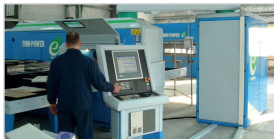
СЕРВОМЕХАНИЧЕСКИЙ РЕВОЛЬВЕРНЫЙ ПРОБИВНОЙ ПРЕСС FINN-POWER
